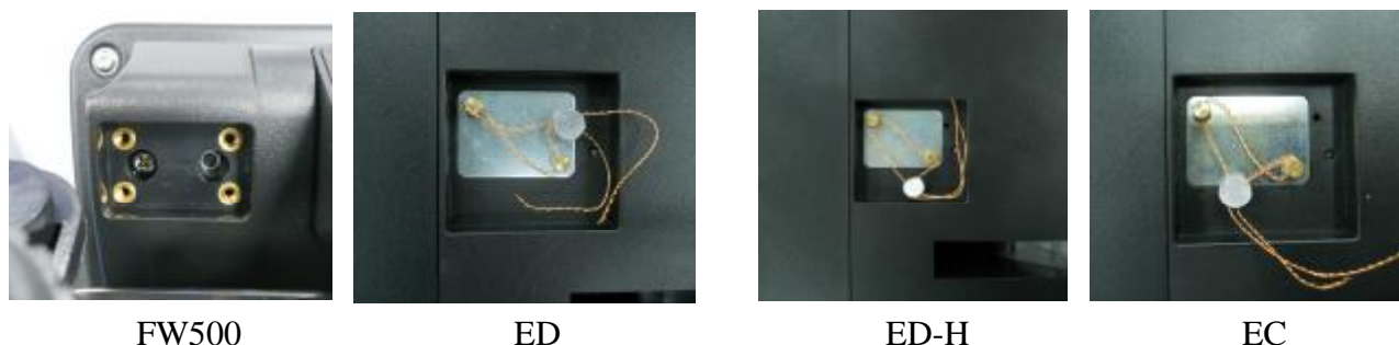
Рисунок 2 – Место пломбировки весов
